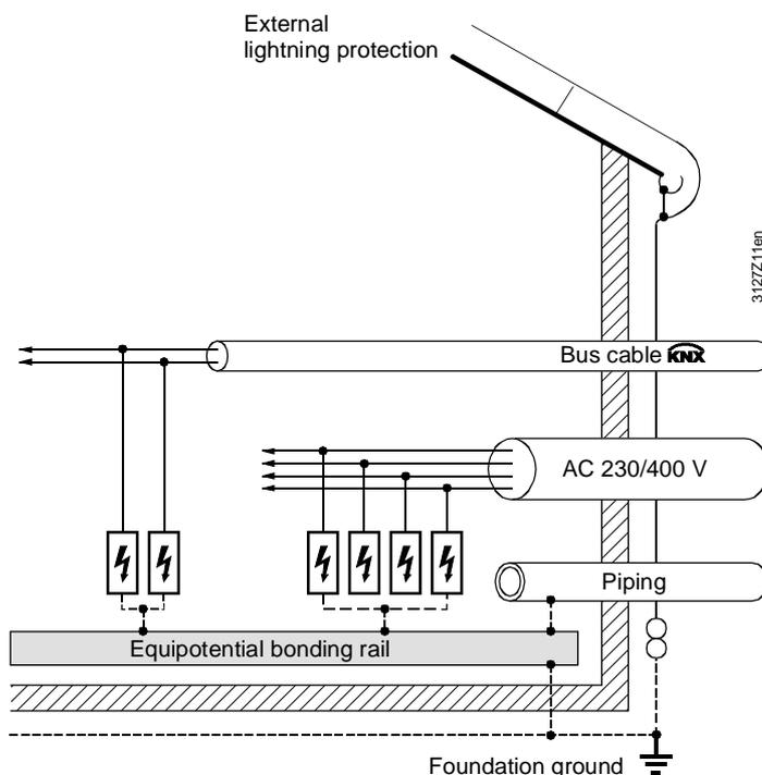
Lightning equipotential bonding (primary protection)
