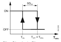
ON D.h.w. charging ON OFF D.h.w. charging OFF
