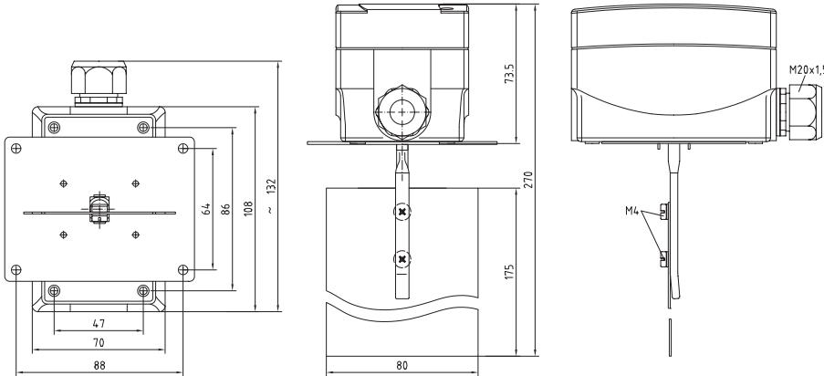
Mechanischer Windfahnenenschalter RHEASREG® WFS, Paddelschalter, Strömungsfühler oder Windfahnenrelais. Er ist geeignet zur Strömungsüberwachung von gasförmigen, nicht aggressiven Medien in Luft- und Klimakanälen, in Zu- oder Abluftgeräten von Ventilatoren oder elektrischen Heizregistern (auch bei verschmutzter, ölhaltiger Luft) oder als Durchflusswächter und Luftströmungswächter einsetzbar.
